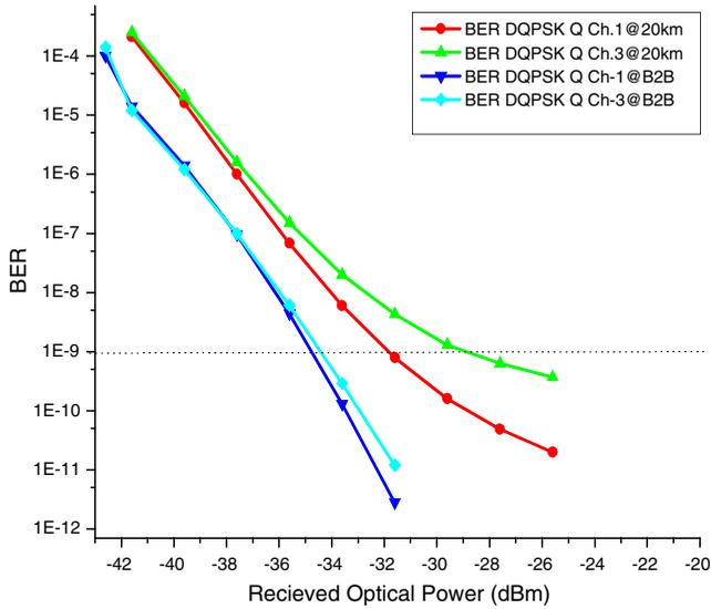
Fig. 4 BER versus R x power DQPSK-Q.
