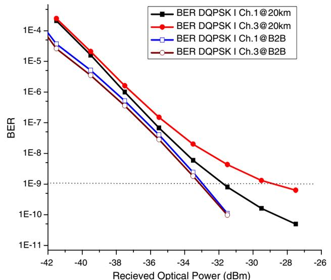
Fig. 3 BER versus R x power DQPSK-I.
