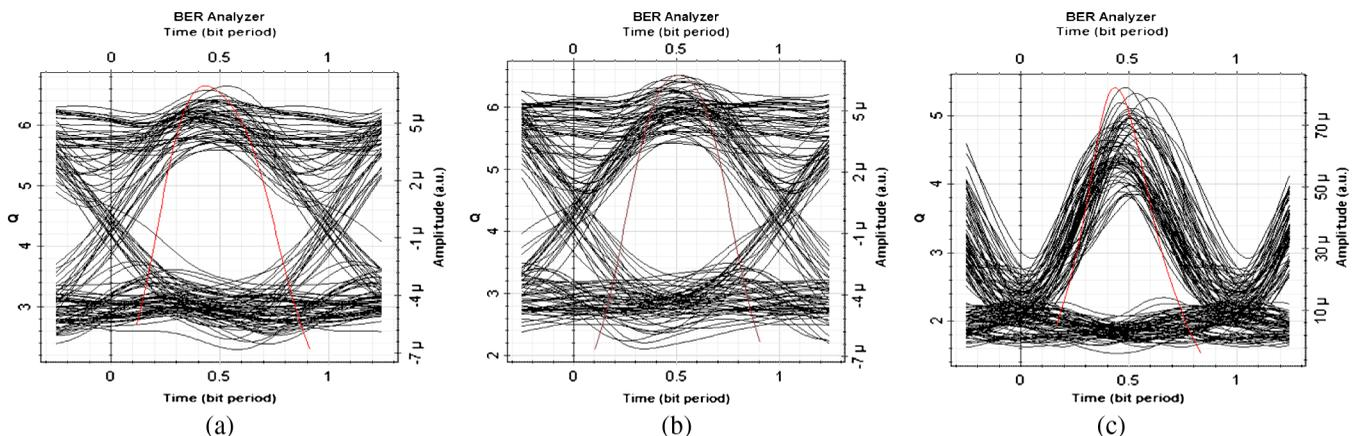
Fig. 6 Eye diagrams: (a) DQPSK-I, (b) DQPSK-Q, (c) OOK from channel 1.
