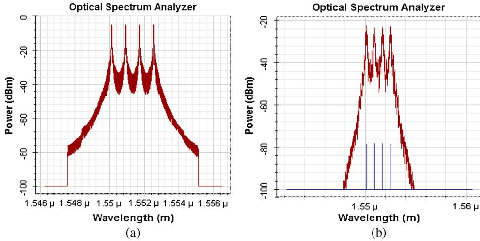
Fig. 2 (a) Four downlink multiplexed DQPSK signal, (b) four uplink multiplexed OOK signal.
